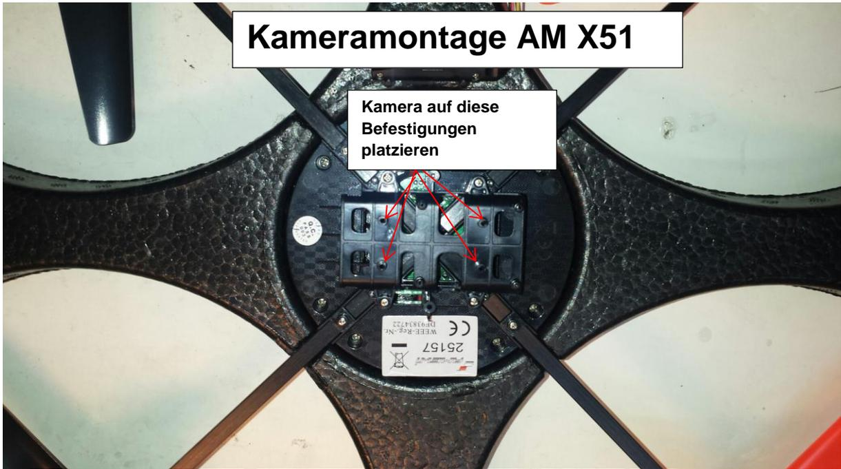
Schrauben mit beiliegendem Werkzeug (Abb. ähnlich.) festschrauben.
