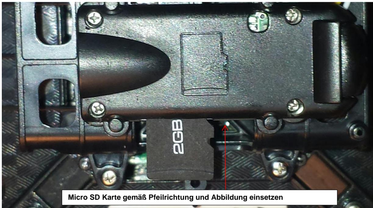
Micro SD Karte gemäß Pfeilrichtung und Abbildung einsetzen
